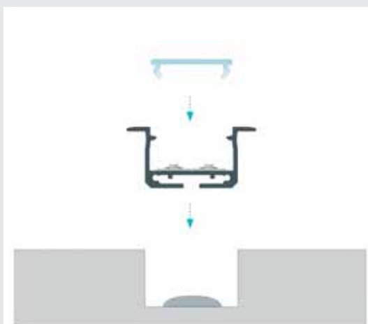
Installazione con colla in scanalatura, inserimento cover
