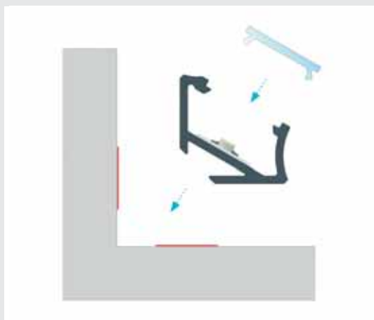
Installazione mediante biadesivo + cover
