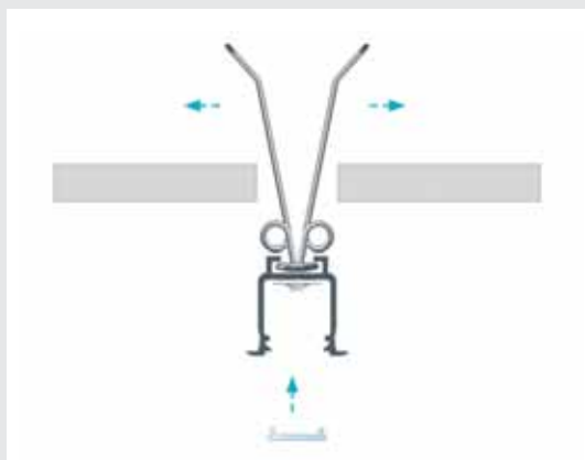
Installazione con molla nel controsoffitto, inserimento cover
