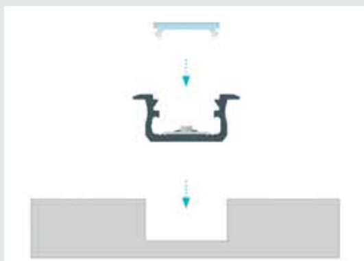
Installazione ed inserimento cover
